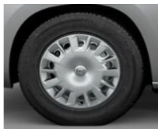
Čelični naplatak 6.5 J x 16, kompletan poklopac kotača
