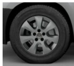
Aluminijski naplatak 6.5 J x 16, 4 dvostruka kraka, srebrna
